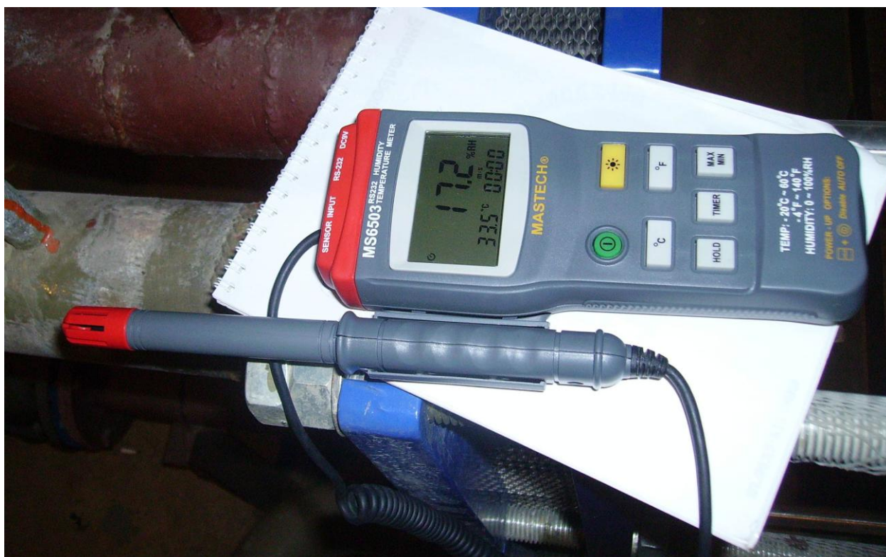
Рис. 5. Контактные измерения поверхности трубы.
