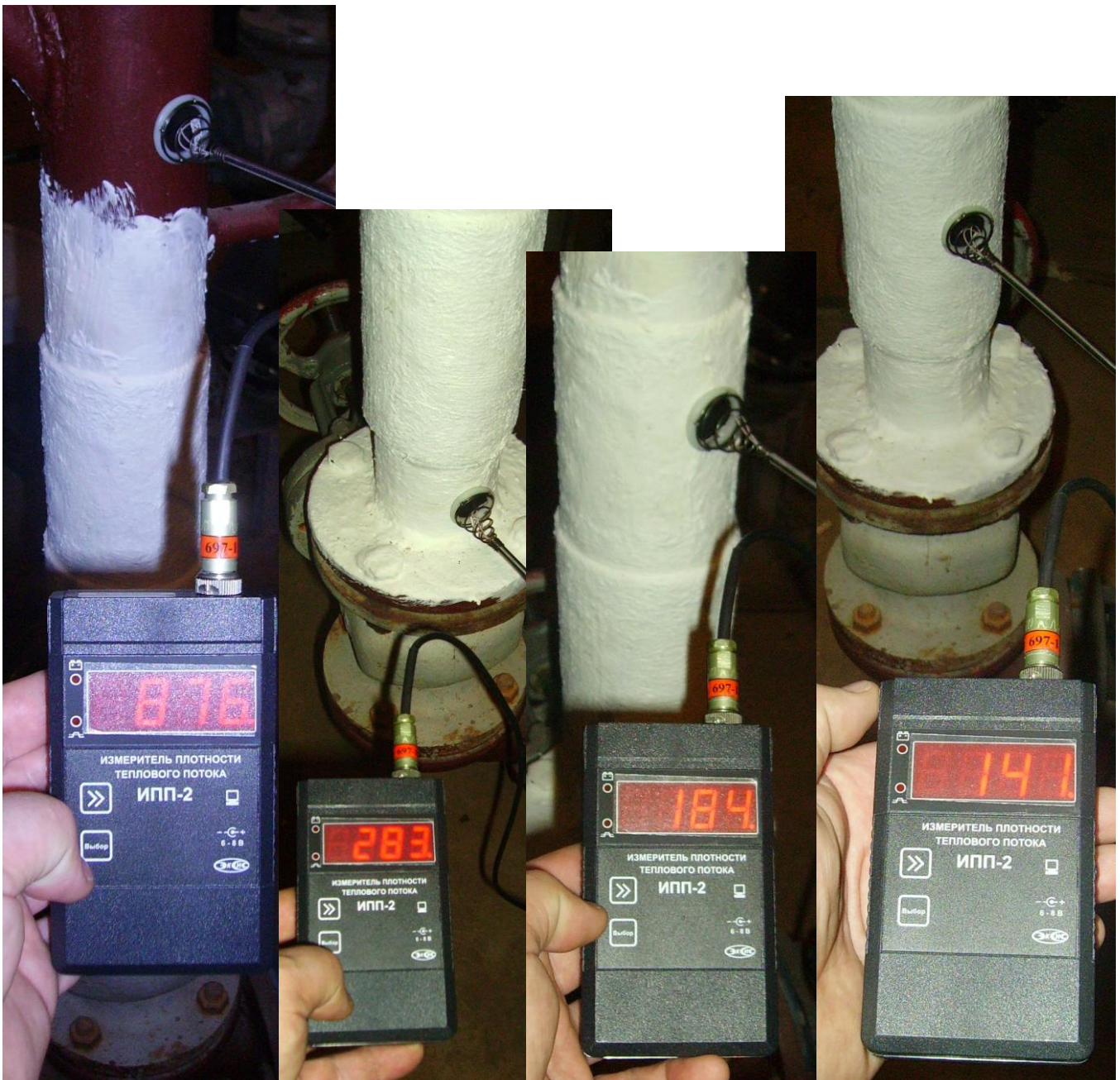
Рис. 3. Измерения плотности теплового потока от поверхности трубы.
