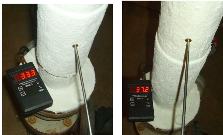
Рис. 5. Контактные измерения поверхности трубы.
